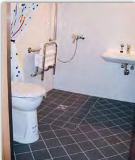
Barrierevermindertes Bad – mit erhöhtem WC, bodengleicher Dusche, Klappsitz und unterfahrbarem Waschbecken
